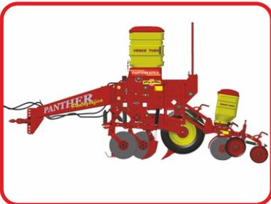
Panther com reservatório de fertilizantes e semente individual (com capacidade 48kg por linha).
