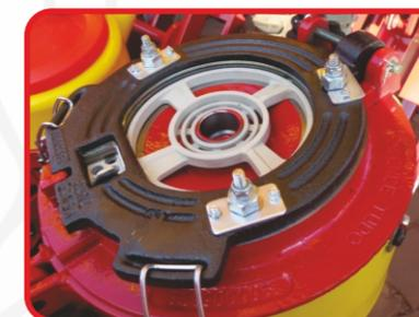
Exclusivo anel corretor de folga (com 3 pontos de ajuste), responsável por fazer a correção de possível folga entre o disco alveolado e o mecanismo dosador conforme espessura do disco, mantendo a precisão na distribuição das sementes.
