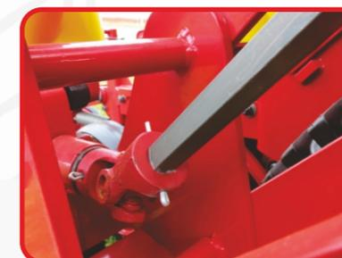
Exclusivo sistema de eixo com cruzeta, melhorando a uniformidade na rotação dos discos que distribuem a semente, proporcionando assim um stand perfeito da cultura a ser implantada.
