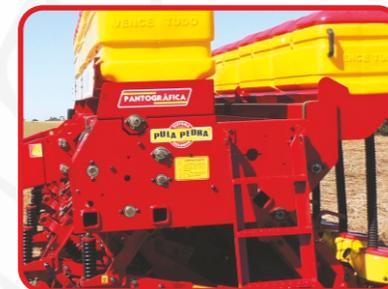
Acesso a plataforma de abastecimento, com escada que facilita o acesso, plataforma ampla e vazada que possibilita a visibilidade para o operador.
