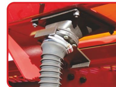
Reservatório da pipoqueira com sistema de esgoto, que facilita o processo de limpeza total da semente em seu reservatório.
