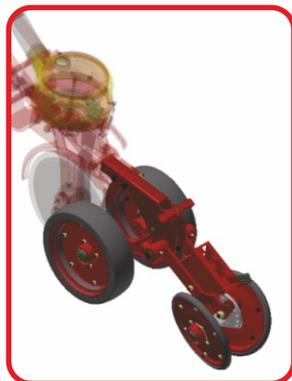
**Limitador Independente e compactador em "V" (Premium):** Limitador e compactador, com várias opções de regulagem, adaptando-se a qualquer tipo de solo. Todas as regulagens, de pressão, profundidade e compactação, sem necessidade de ferramentas.
