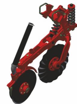
Conjunto linha independente com disco de corte turbo de 18'' e disco duplo 15x15'' desengatado, para incorporar o fertilizante.
