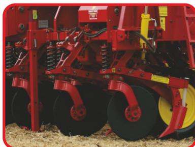
Equipada com discos de corte de 17", 18" ou 20", intercalados a 320mm, proporcionando maior vazão para o fluxo da palha. Maior altura entre chassi e o solo, possibilitando a passagem dos restos de cultivo.
