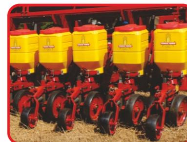
Reservatório de semente individual em polietileno, com capacidade de 38 kg/48 l. Com sistema de dosador por discos perfurados para diferentes culturas oferecendo uma elevada precisão na distribuição da semente.
