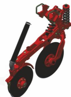
Conjunto linha independente com disco de corte liso de 18'' e disco duplo 15x15'' desengatado, para incorporar o fertilizante.
